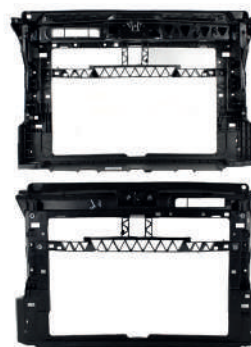
MARCO RADIADOR PLASTICO (GASOLINA) (POLO 13-22)
